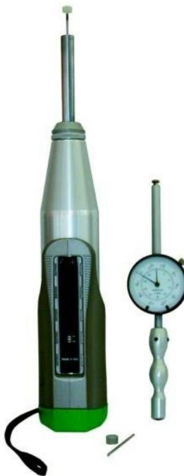
Figura 14 Si osserva il penetrometro meccanico Wood Pecker utilizzato per l'indagine sclerometrica sul legno.
