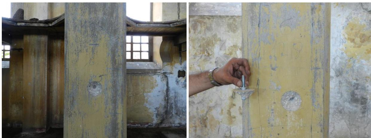
Figura 3 A sinistra si osserva il foro effettuato sulla parete del pilastro durante la prova pull-out: a destra è possibile osservare il cono di estrazione.
