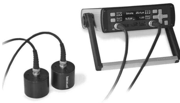
Figura 7 Si osserva il Proceq modello Pundit Lab+, strumento utilizzato per condurre le indagini ultrasoniche.
