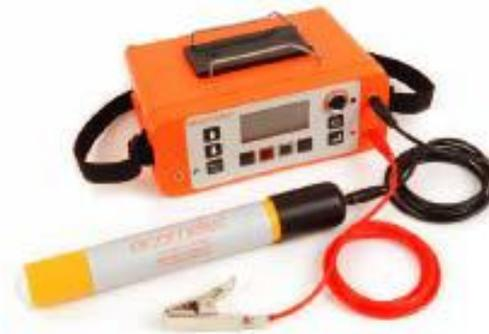
Figura 11 L'immagine mostra il Pacometro P331-Serie H corredato della semicella avente l'elettrodo di Rame-Solfato di Rama ( $\text{Cu-CuSO}_4$ ), utilizzato per la misura del potenziale di corrosione.
