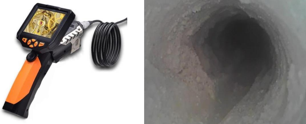
Figura 6 A sinistra si osserva l'endoscopio utilizzato per l'esecuzione dell'indagine; a destra è possibile osservare un fotogramma della struttura muraria.
