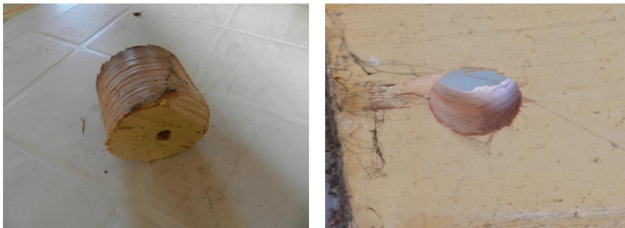
Figura 9 A sinistra si osserva la carota estratta dal soppalco; mentre a destra si osserva il foto ottenuto a seguito del carotaggio.
