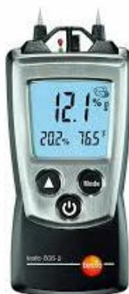
Figura 8 Misuratore di umidità Testo modello 606-2; utilizzato per la misurazione dell'umidità e della temperatura nelle strutture lignee.
